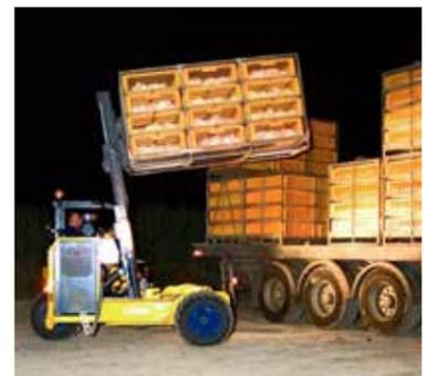
Der M10 ist der Spezialist für das einseitige Abladen und verfügt über Gabeln und einen Ausschubarm.
